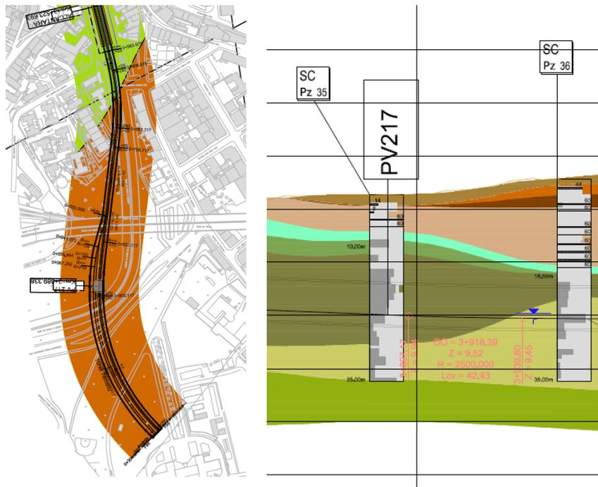
Figura 1 – Planta e perfil longitudinal – Geologia / Geotecnia.
