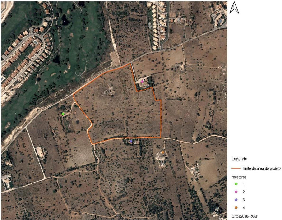
No âmbito do anterior estudo de impacte ambiental foram realizadas medições in situ em 9 pontos, três dos quais compreenderam os recetores 1 e 2. Como resultado destas medições constatou-se que as principais fontes de ruído nestes pontos correspondiam ao tráfego rodoviário da EN125.
