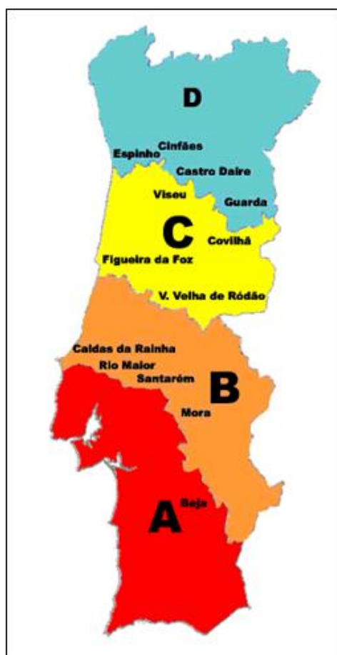
Figura 7.16 – Zonamento do risco sísmico em Portugal Continental
