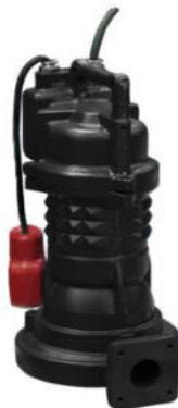
Bomba submersível **EBARA**, modelo **DRS/A65-230-14,9**, fornecida como uma unidade compacta, composta essencialmente pela bomba com corpo de voluta em ferro fundido GG-20, **impulsor Triturador** em ferro fundido GG-25, veio comum em aço inoxidável AISI 420B, e pelo **motor trifásico de 2 pólos (2900 rpm)** com **14,9 kW**, classe de isolamento H, protecção IP 68, com sensor bimetálico, encapsulado em carcaça de ferro fundido GG-25, com cabo de 10 metros em Neopreno HO7RN/F.
