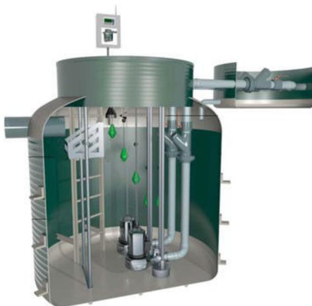
Na Estação Elevatória de Bombagem de **Águas Residuais** será considerado um poço de bombagem em PRFV (Poliéster reforçado com fibra de vidro) **de volume 2500 litros modelo SANIRELEV MAXI SL-3B** onde serão instalados grupos de bombagem submersíveis, de construção robusta, e os restantes acessórios mecânicos (**válvulas e bóias de nível**) e eléctricos (**quadro de comando**) para o seu bom funcionamento.
