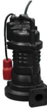
Bomba submersível **EBARA**, modelo **DRS/A40-135-1,6**, fornecida como uma unidade compacta, composta essencialmente pela bomba com corpo de voluta em ferro fundido GG-20, **impulsor Triturador** em ferro fundido GG-25, veio comum em aço inoxidável AISI 420B, e pelo **motor trifásico de 2 pólos (2900 rpm)** com **1,6 kW**, classe de isolamento H, protecção IP 68, com sensor bimetálico, encapsulado em carcaça de ferro fundido GG-25, com cabo de 10 metros em Neopreno HO7RN/F.
