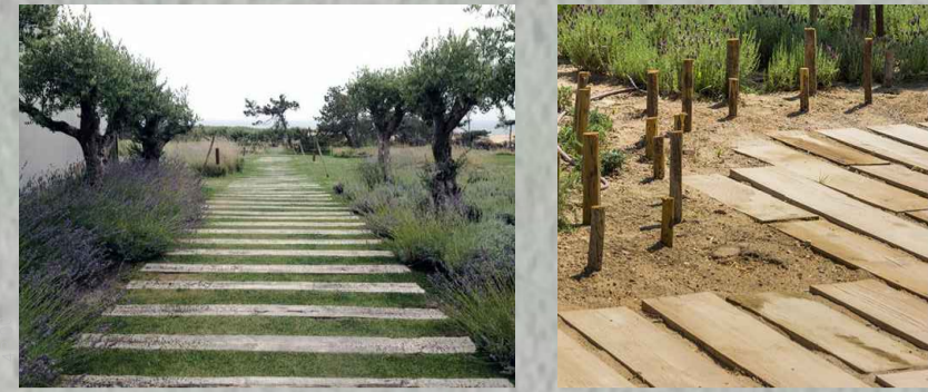
PAVIMENTO COM TRAVESSAS DE MADEIRA
