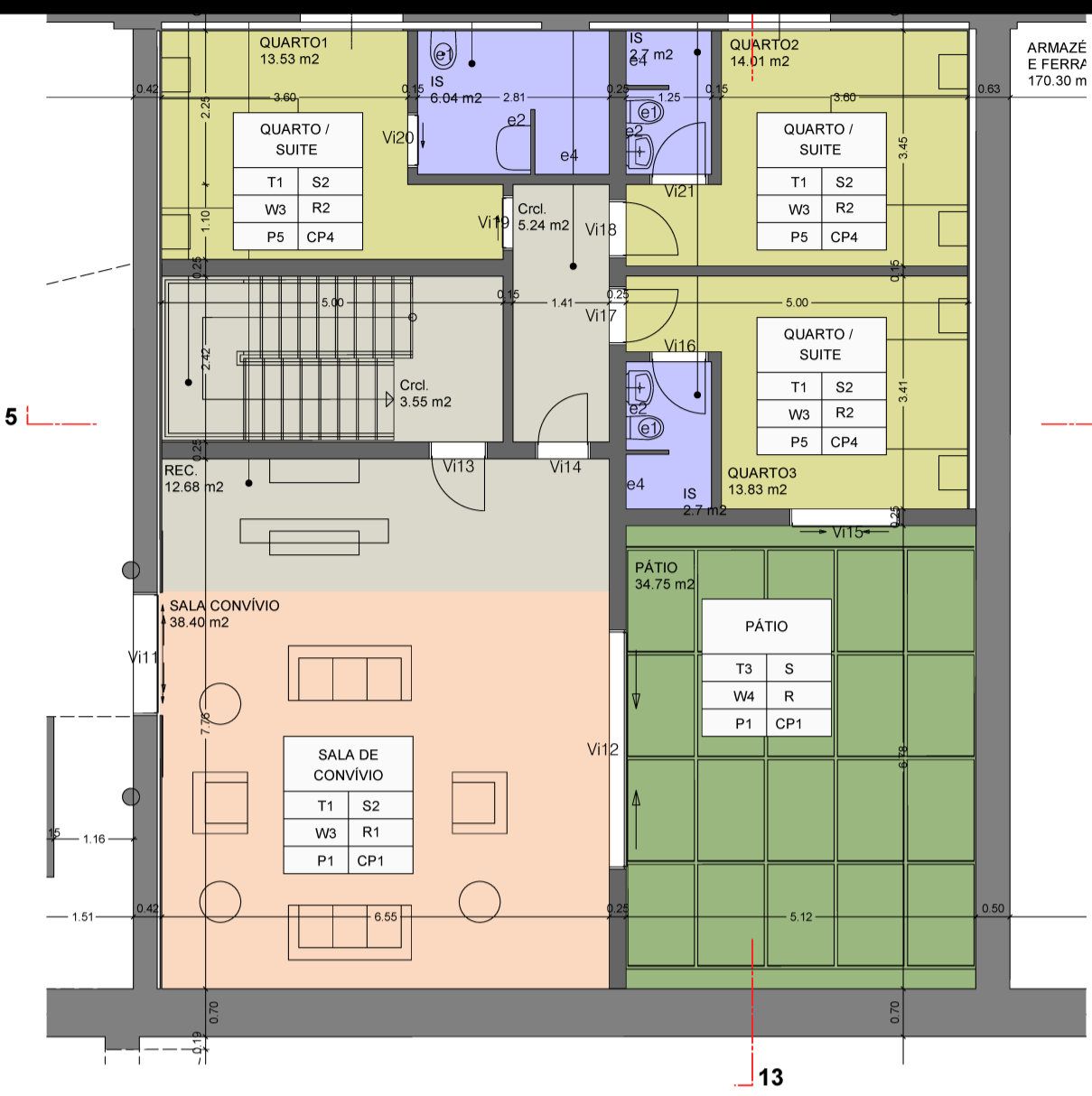
PLANTA DA ZONA E - PISO 00 Esc. 1/100
