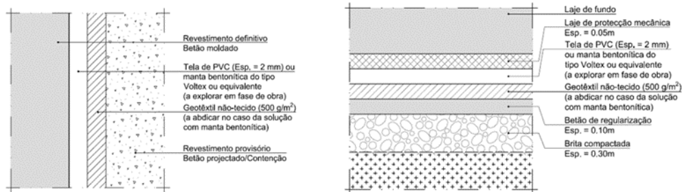
Figura 3.116 - Sistema de impermeabilização do revestimento definitivo das estruturas executadas a céu aberto
