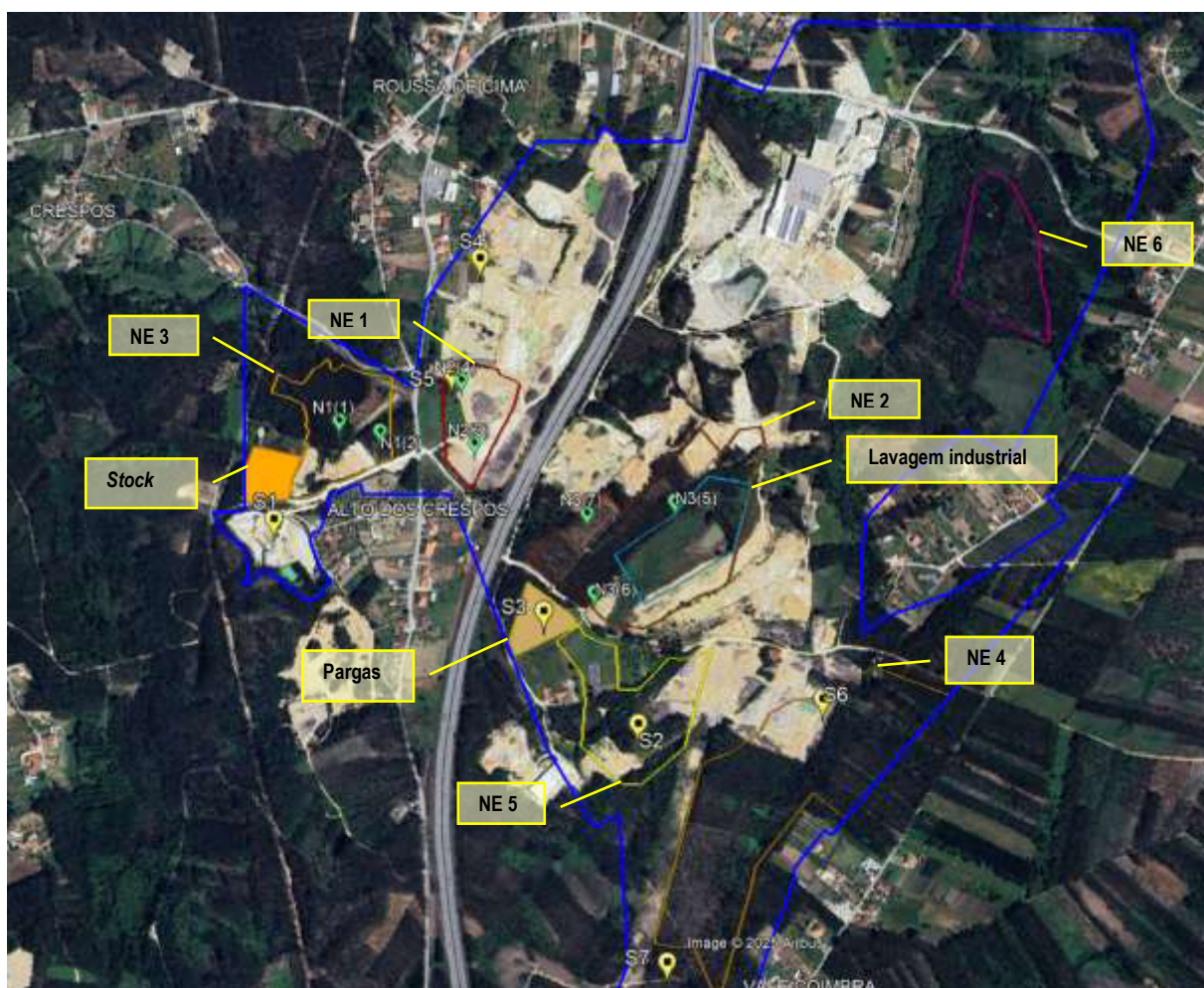
Figura 4 - Locais de amostragem do solo superficial e implantação das sondagens geológico-geotécnicas
