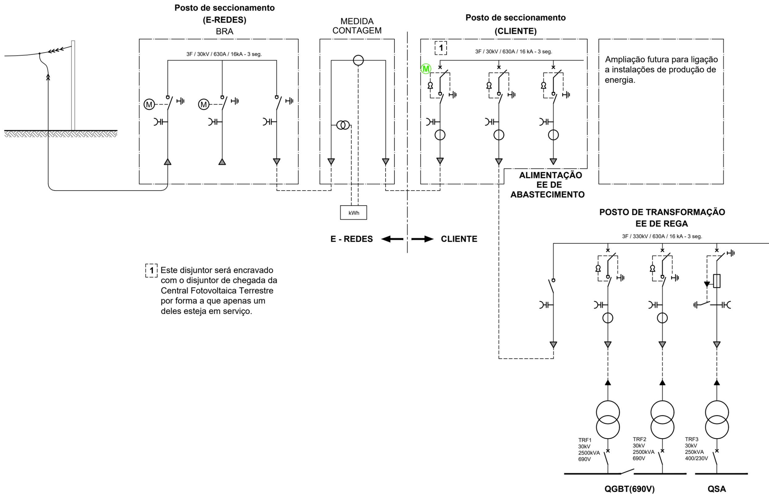
**1** Este disjuntor será encravado com o disjuntor de chegada da Central Fotovoltaica Terrestre por forma a que apenas um deles esteja em serviço.
