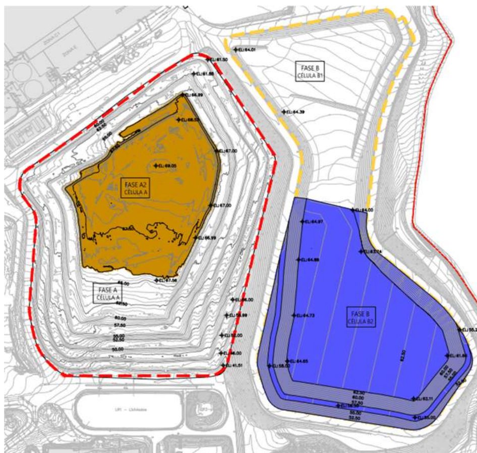
Figura 5-4 – Enchimento da Fase B2 até à cota máxima licenciada de +65,0 m
