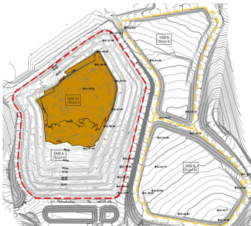
Figura 5-2 – Enchimento da Fase A2 desde a cota de +66,5 m até às cotas atuais do levantamento de dezembro 2023
