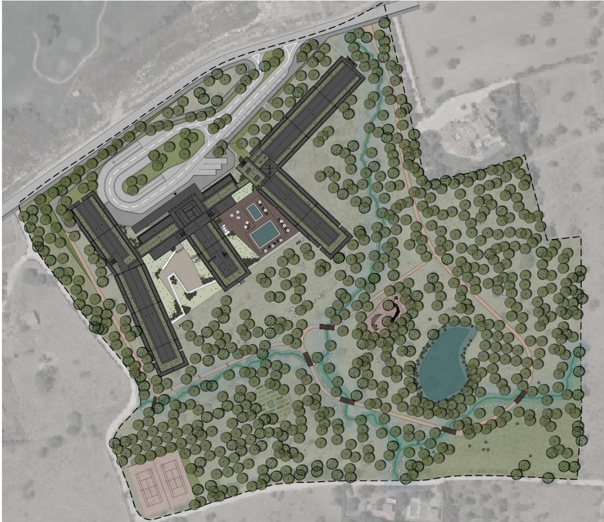
A propriedade é atravessada por três corredores de drenagem natural. Alguns troços serão desviados e reperfilados. A solução proposta para o revestimento e estabilização das margens recorre a técnicas de engenharia naturais, utilizando pedra local de origem natural, de forma a reduzir a velocidade da água e promovendo alguns pontos de alargamento para promover a infiltração da água no solo e reduzir a erosão.
