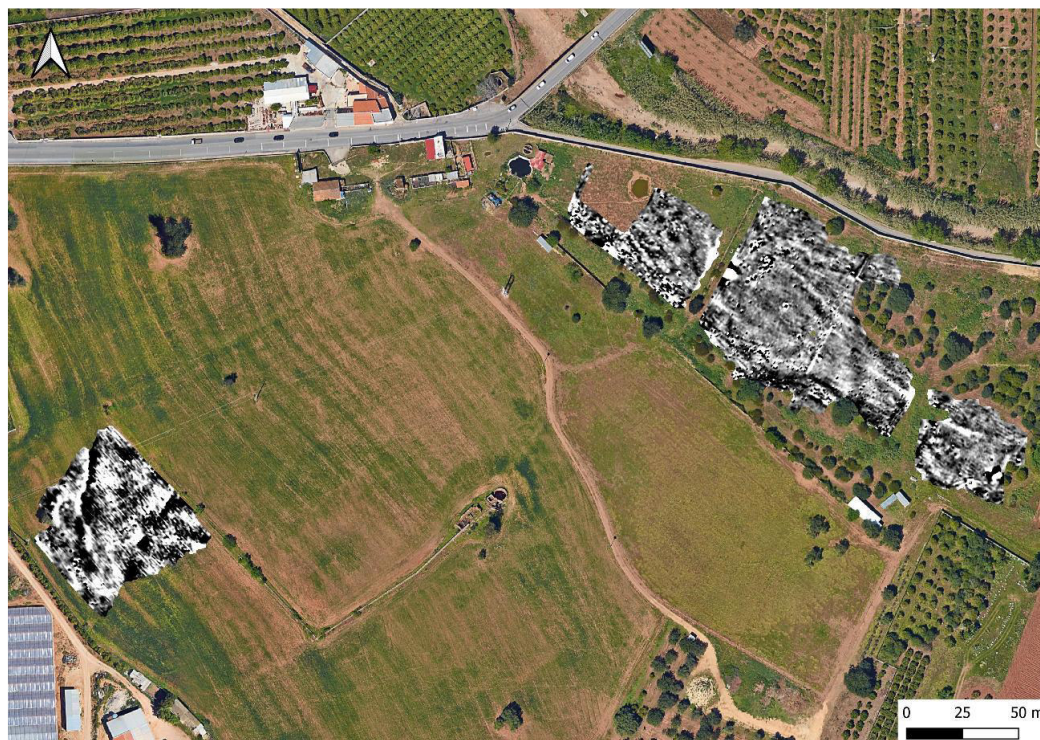
Figura 7.13 – Dados RAW (-1nT/1nT) da área alvo de levantamento geofísico.
