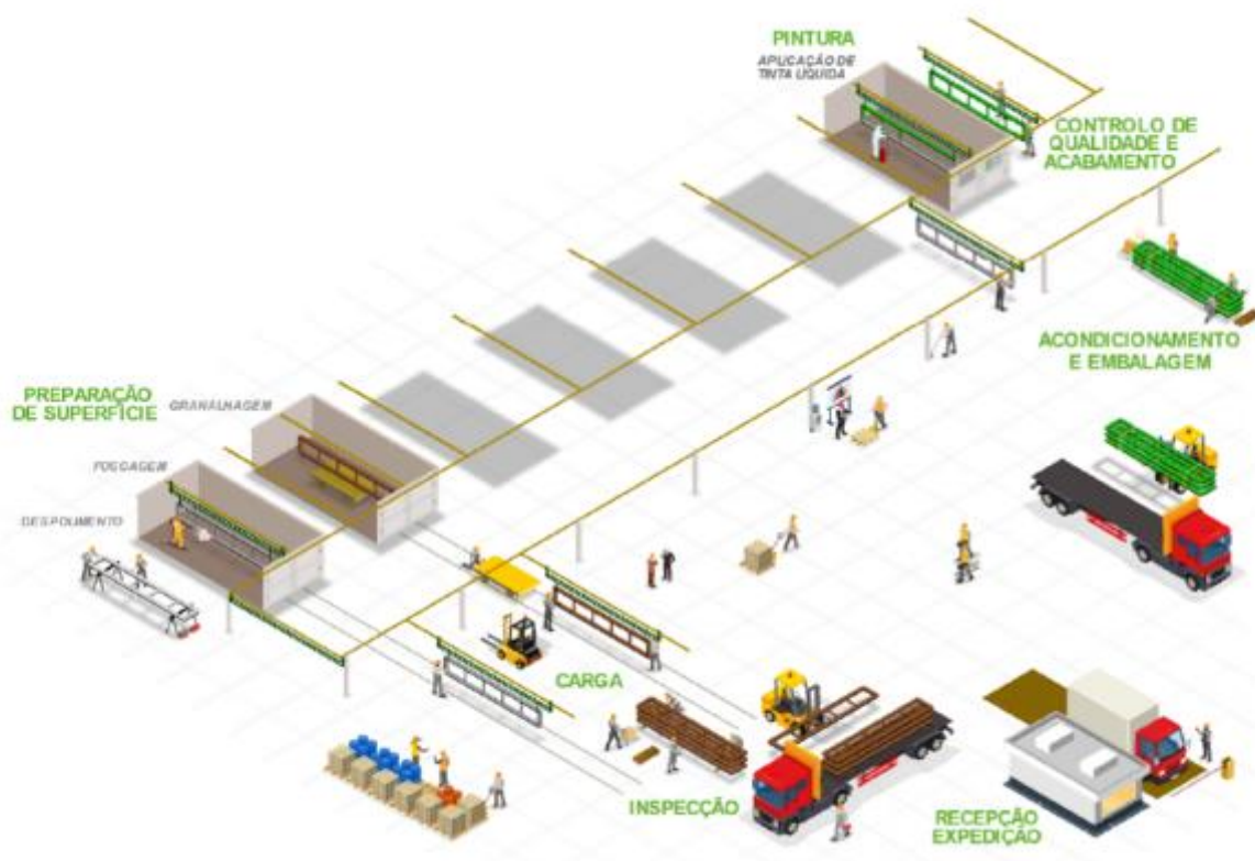
Figura 9 – Esquema do layout da pintura líquida.
