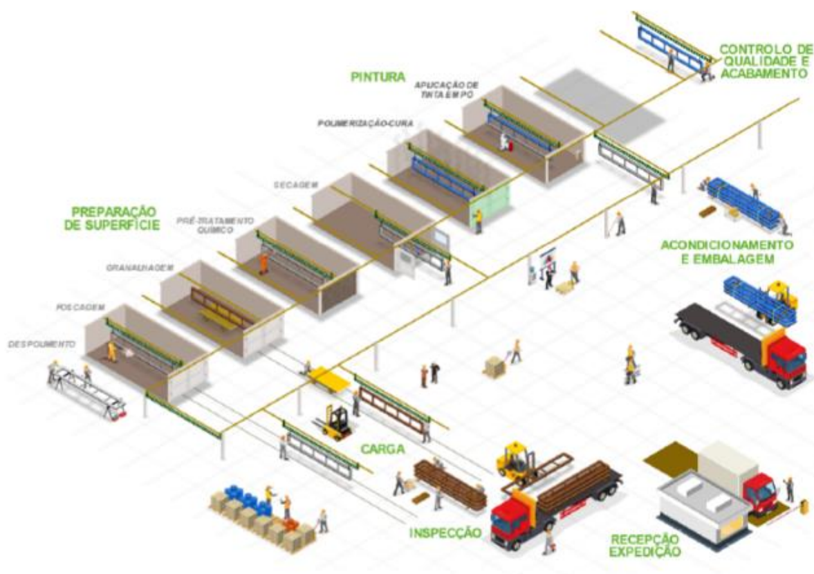
Figura 17 – Esquema do layout da lacagem.
