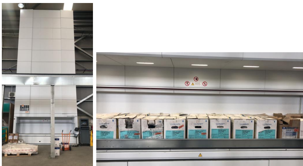
Figura 16 – Armazenagem de tintas em pó – linha manual e automática.
