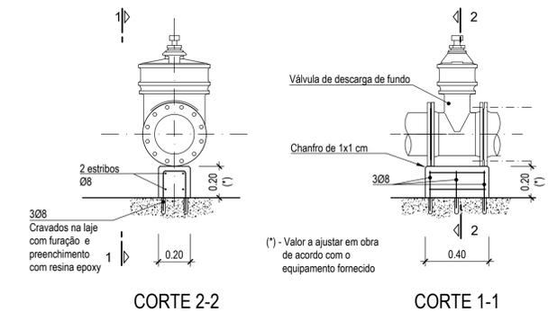
APOIO DA VÁLVULA - Detalhe
