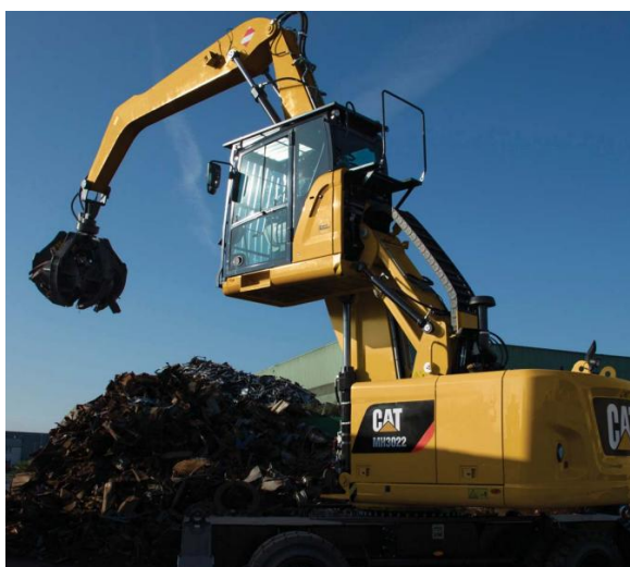
Figura 31. Exemplo de um manobrador com pinça.
