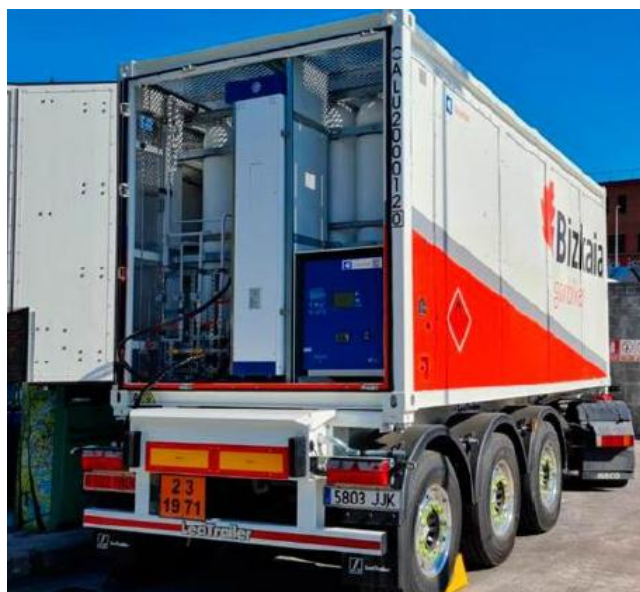
Figura 12. Exemplo de camião de transporte de BioGNC.
