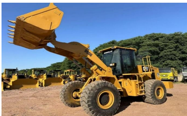
Figura 30. Exemplo de uma pá carregadora frontal.
