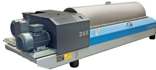
Figura 28. Exemplo de uma centrífuga.
