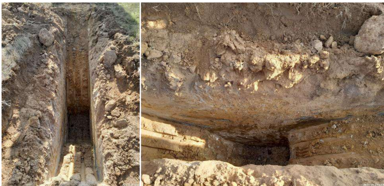
Figura 23 – Aspetto geral do poço P1 (poço que atingiu a maior profundidade – 2,60 m).
