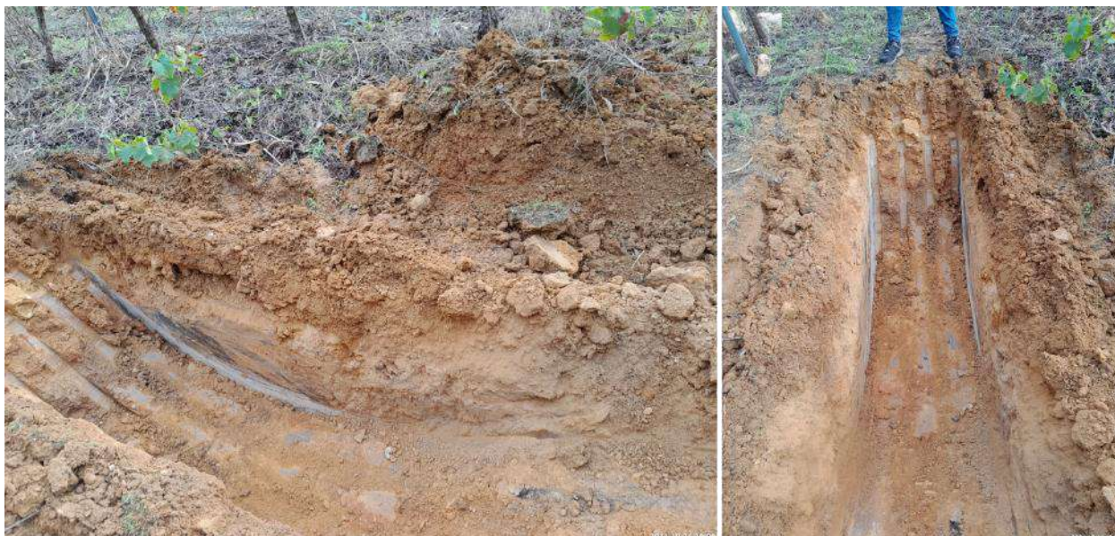
Figura 22 – Aspetto geral do poço P10 (poço que atingiu a menor profundidade – 0,90 m)
