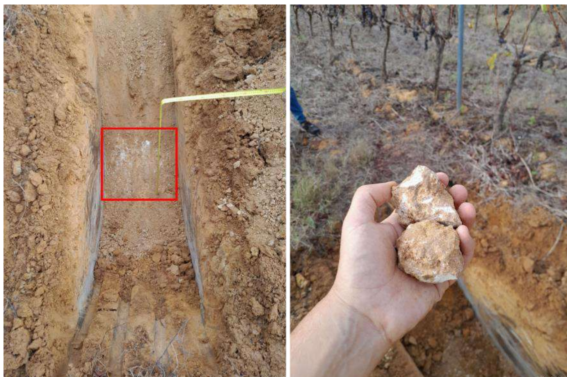
Figura 30 – Fotografia esquerda: Fundo do poço P9, que aparenta ter terminado num nível de calcário; Fotografia direita: Fragmentos de calcário colhidos do fundo do poço
