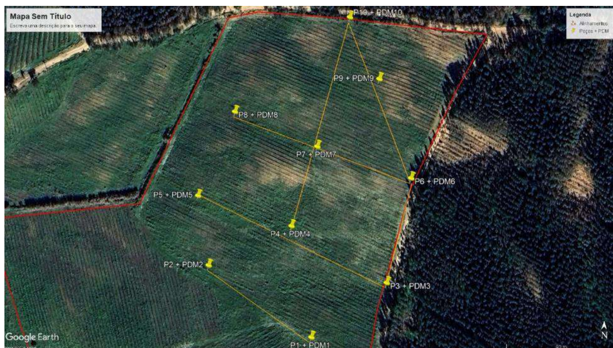
Figura 33 – Representação em planta da prospeção geológica-geotécnica executada. O limite a vermelho marca o limite da propriedade interessada. As linhas a laranja indicam os alinhamentos analisados.
