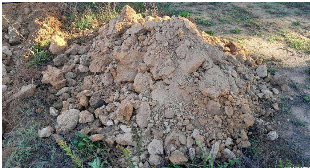
Figura 29 – Solos escavados no poço P3 (0,30 – 0,90 m), onde são visíveis fragmentos areníticos de dimensão apreciável ( D_{\text{máx}} \approx 0,30 \text{ m} )
