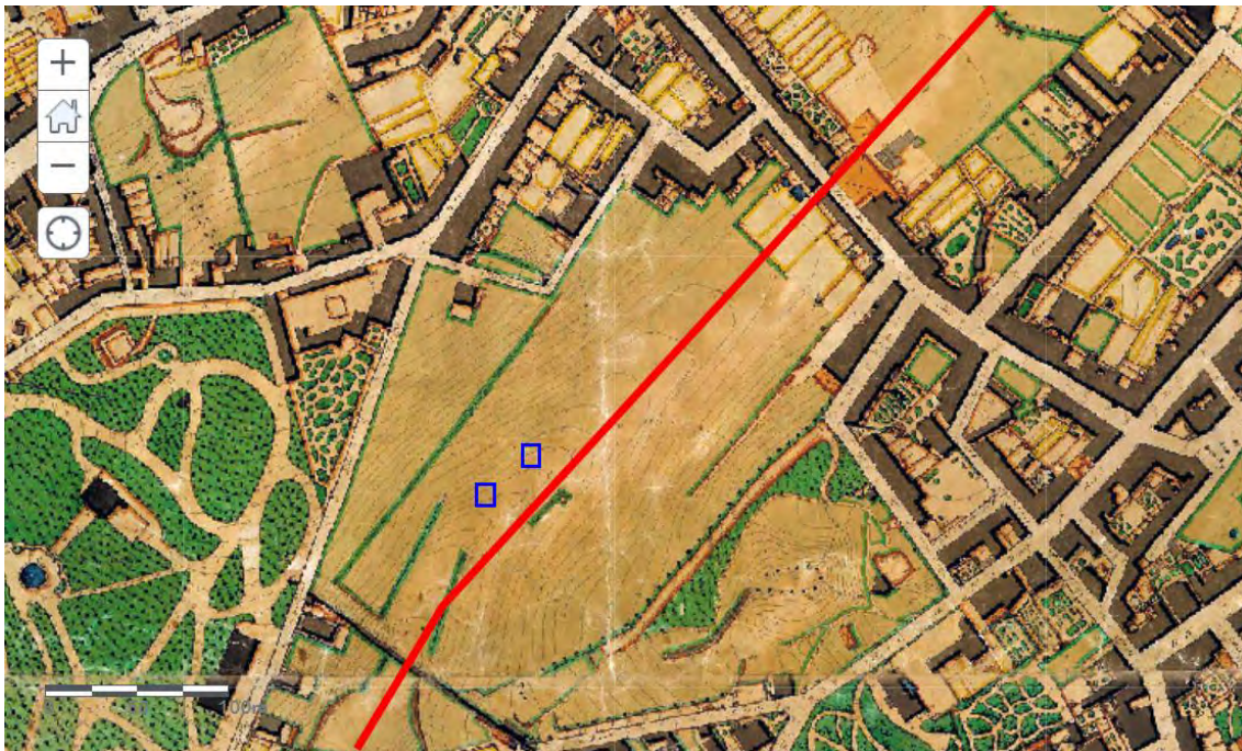
Figura 364 – Cartografia de 1911 da zona onde foi construída a Av. Infante Santo, cujo traçado atual se representa a vermelho. A azul marcam-se as sondagens 1 e 2 realizadas na sua margem.
