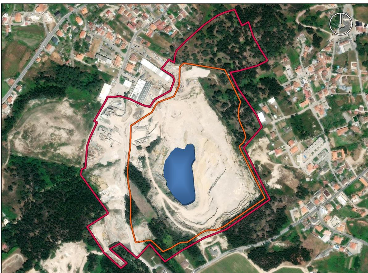
**Figura 3 – Área a licenciar (vermelho) e localização da bacia de retenção (azul - poço de fundo de pedreira).**
