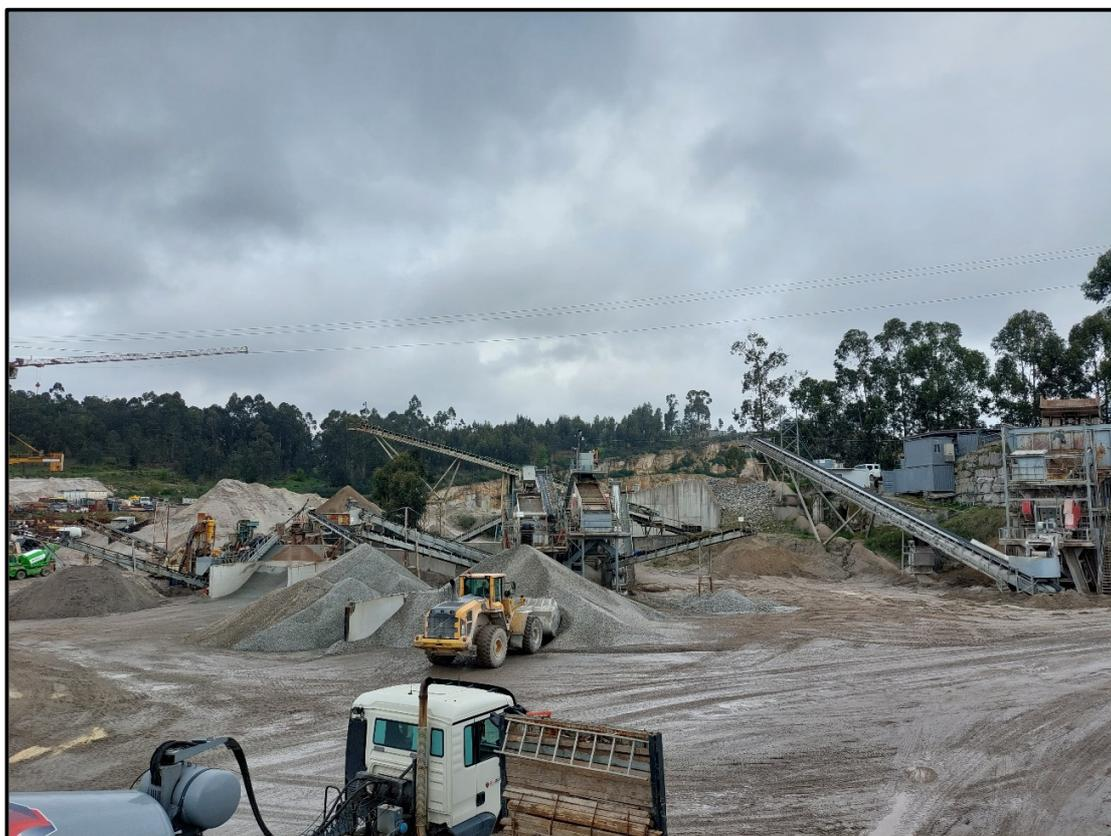
**Fotografia nº 3:** Vista parcial da instalação de britagem
