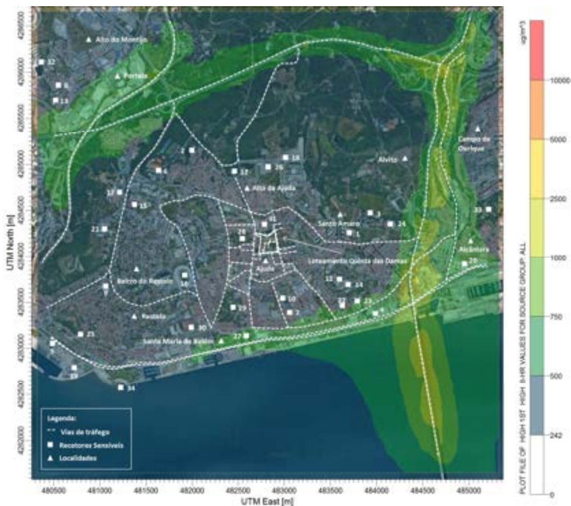
Figura 137 - Campo estimado das concentrações máximas das médias octohorárias de CO ( \mu\text{g}\cdot\text{m}^{-3} ) verificadas no domínio em análise (situação futura), para o Cenário Cumulativo.
