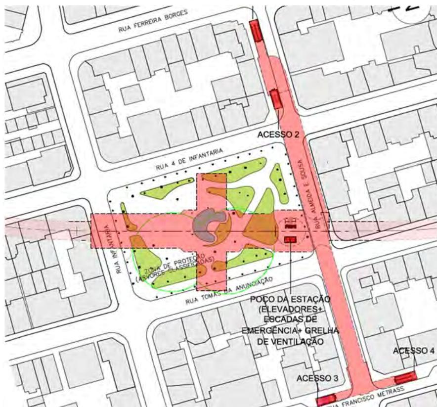
Figura 3 - Estação de Campo de Ourique (estação enterrada a 30m de profundidade), imagem extraída de documento atualizado<sup>5</sup> com a seguinte legenda: *Estação Campo de Ourique - Implantação conforme Anexo Z das 'bocas de acesso' à superfície (E1/E2/E3 e E4).*
