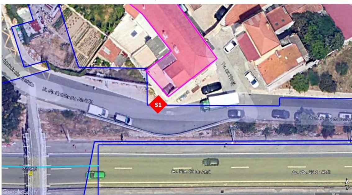
Figura 36 – Localização da sondagem de diagnóstico junto ao alçado sul. A azul marcam-se os limites das novas vias a construir no âmbito da Estação de Alcântara, a rosa os limites do antigo Palácio Fiúza e a vermelho a sondagem de diagnóstico.
