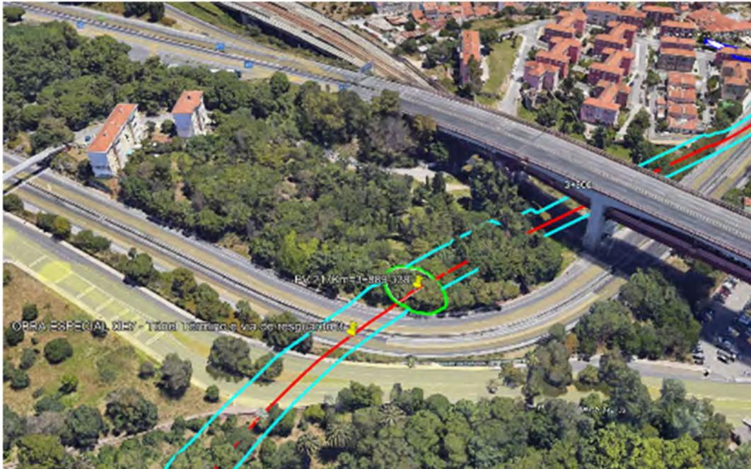
Figura 9 - PV 217 no Pk 3+889,338. Imagem extraída de documento atualizado<sup>11</sup> com a seguinte legenda: Poço de Ventilação PV217(Km 3+889.338) e passagem do túnel junto à fundação do pilar do viaduto de acesso à Ponte 25 de Abril. - implantação em Google Earth.
