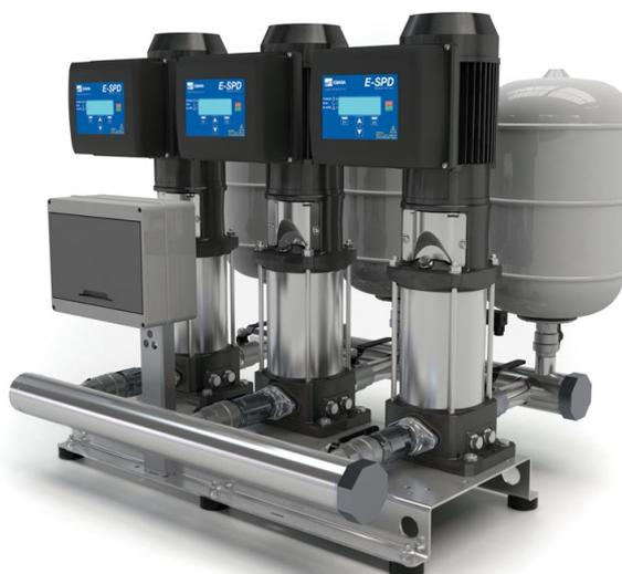
Grupo hidropressor com variação de velocidade para todas as bombas, com variadores montados no motor, para abastecimento da rede de água para consumo.
