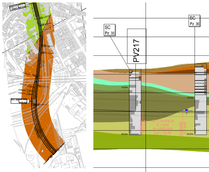
Figura 1 – Planta e perfil longitudinal – Geologia / Geotecnia.
