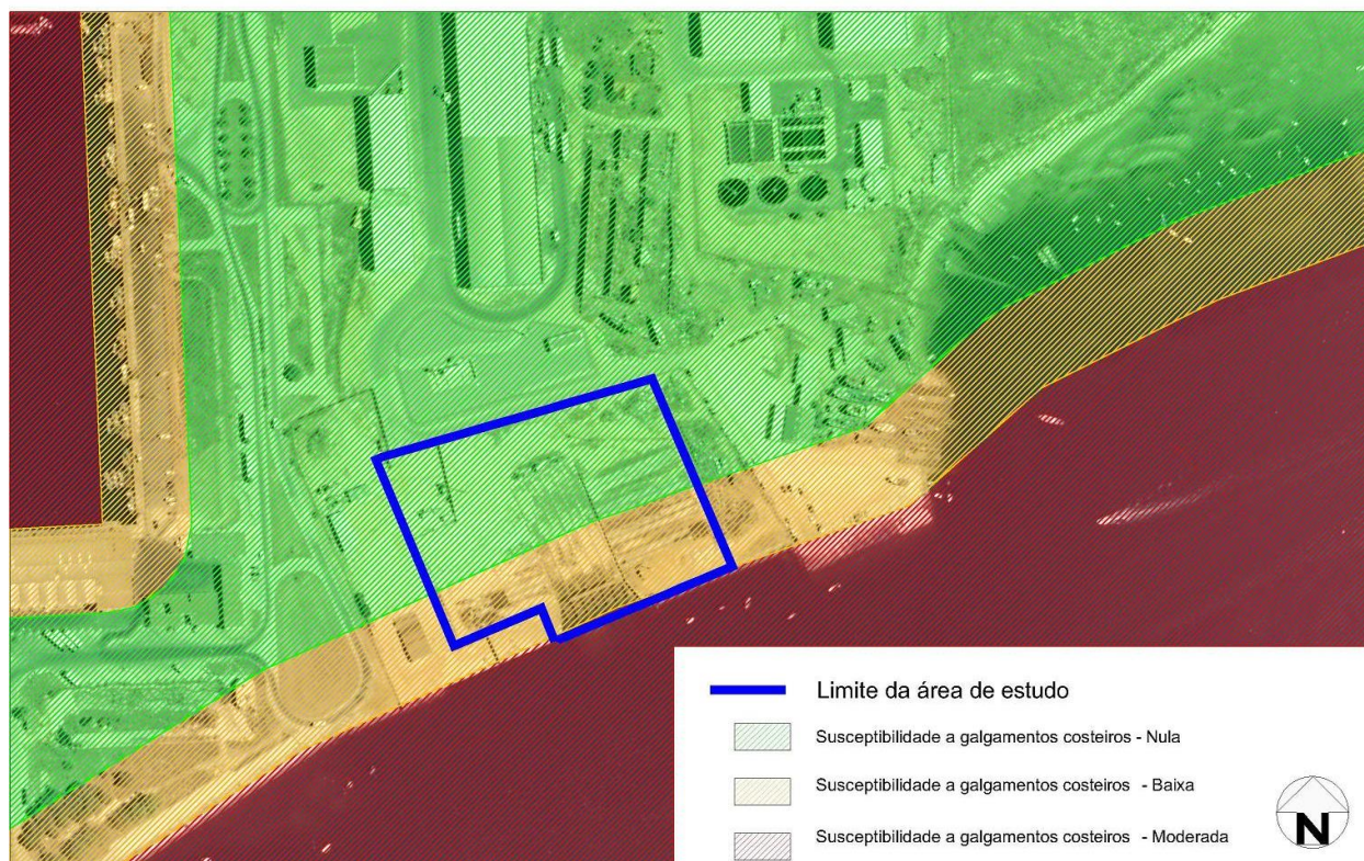
Figura 13 – Risco de galgamento costeiro.
