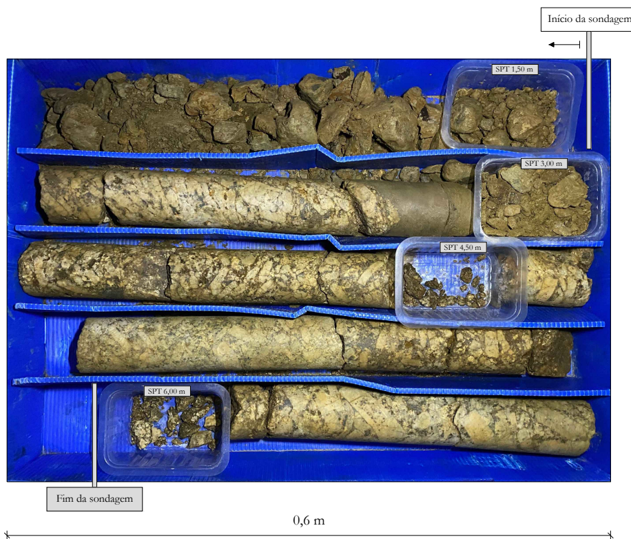
Figura B.3.1 - Fotografia dos testemunhos da sondagem S3.
