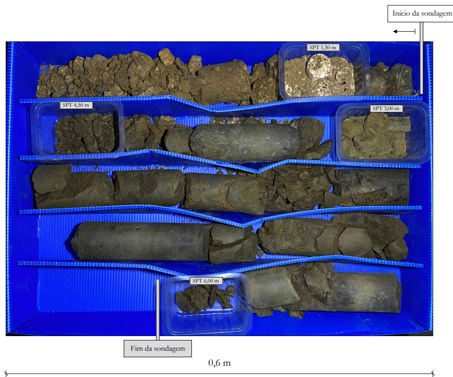
Figura B.9.1 - Fotografia dos testemunhos da sondagem S9.
