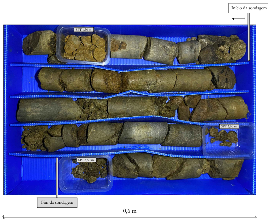
Figura B.1.1 - Fotografia dos testemunhos da sondagem S1/Pz.
