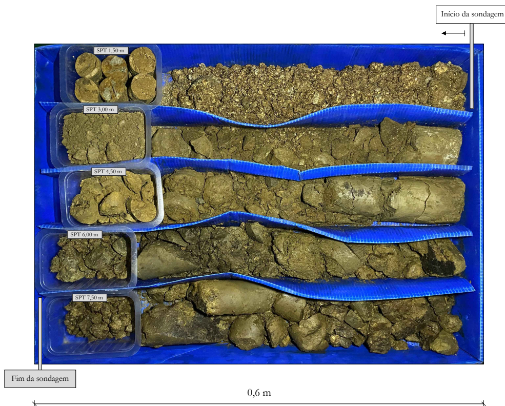
Figura B.6.1 - Fotografia dos testemunhos da sondagem S6/Pz.
