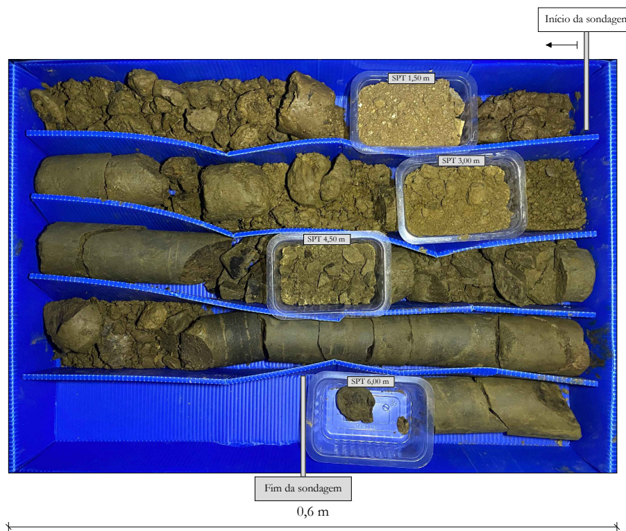
Figura B.8.1 - Fotografia dos testemunhos da sondagem S8.
