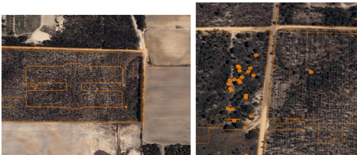
Figura 49: Implantação do levantamento topográfico (a cor de laranja) no ortofotomapa.
