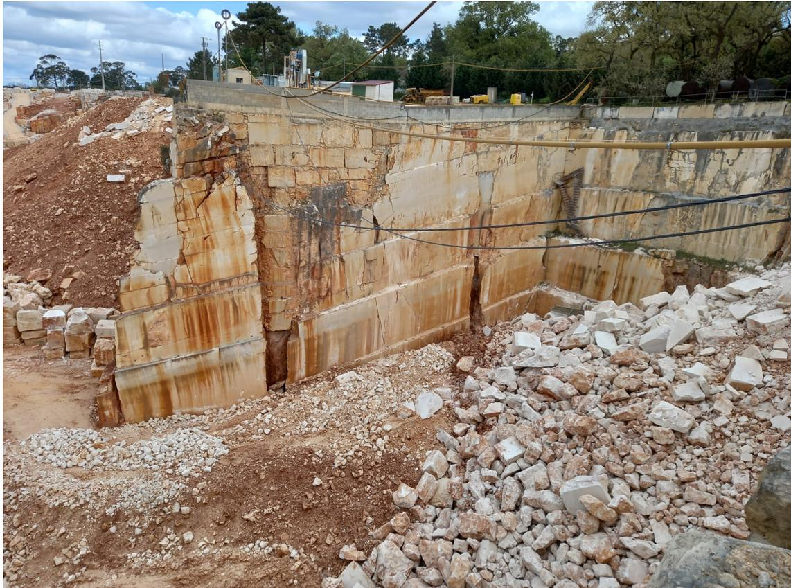
Fot.3 – Pormenor da colmatção com inertes de uma área já explorada.
