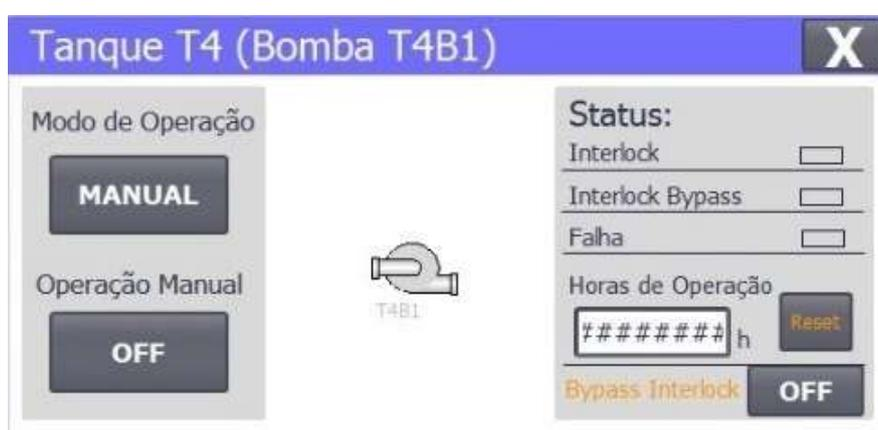
Figura 30 – Menu de operação de bomba T4B1
