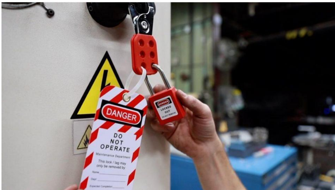
Figura 2.4 - Sistema de proteção Lockout Tagout
