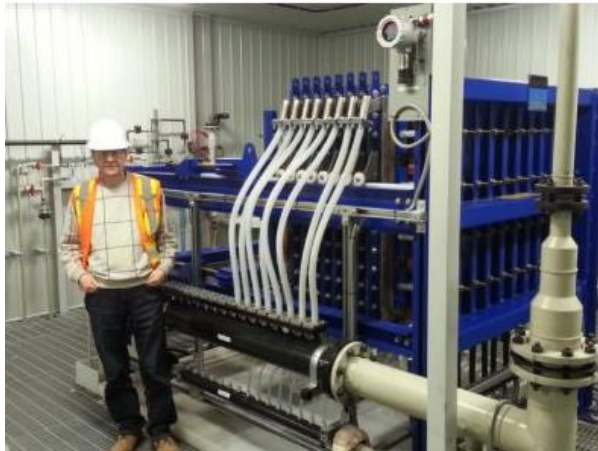
Figura 3.3 – Eletrolisador de membranas NORSCAND® A15F08Cl2
