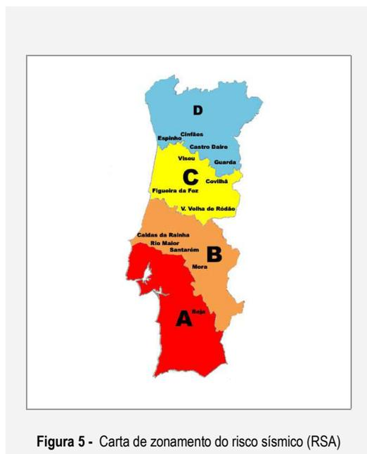
Figura 5 - Carta de zonamento do risco sísmico (RSA)
