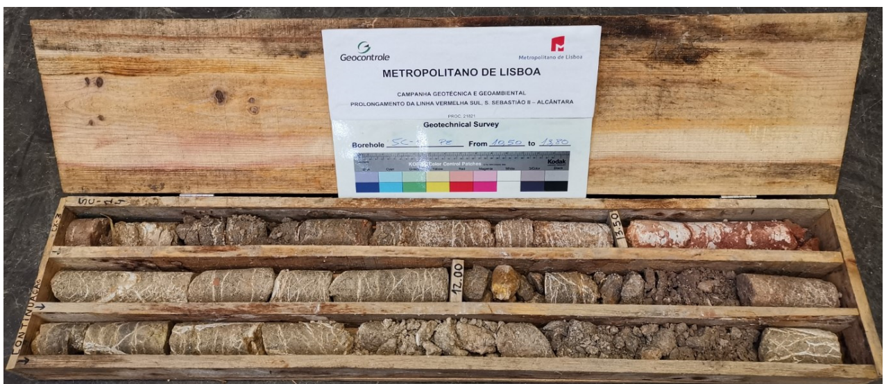
TESTEMUNHO DA SONDAGEM SC14
