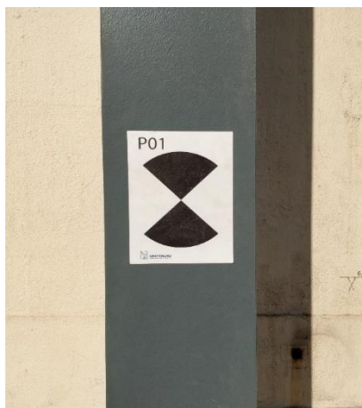
Figura 7 - Alvo magnético sobre uma viga
