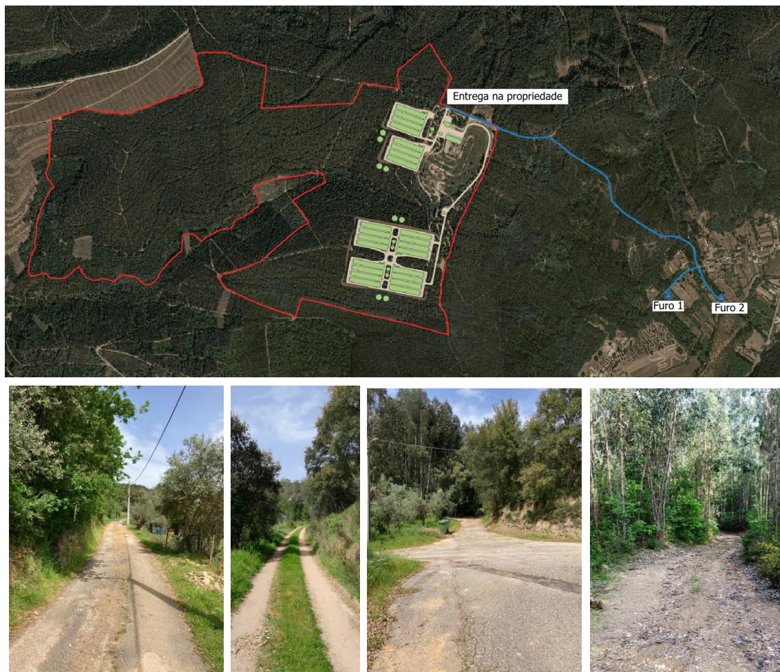
Figura 4. Em cima: implantação do projeto de abastecimento de água. Em baixo: aspeto dos caminhos e acessos existentes onde serão executadas as valas para instalação de tubagem adutora.
