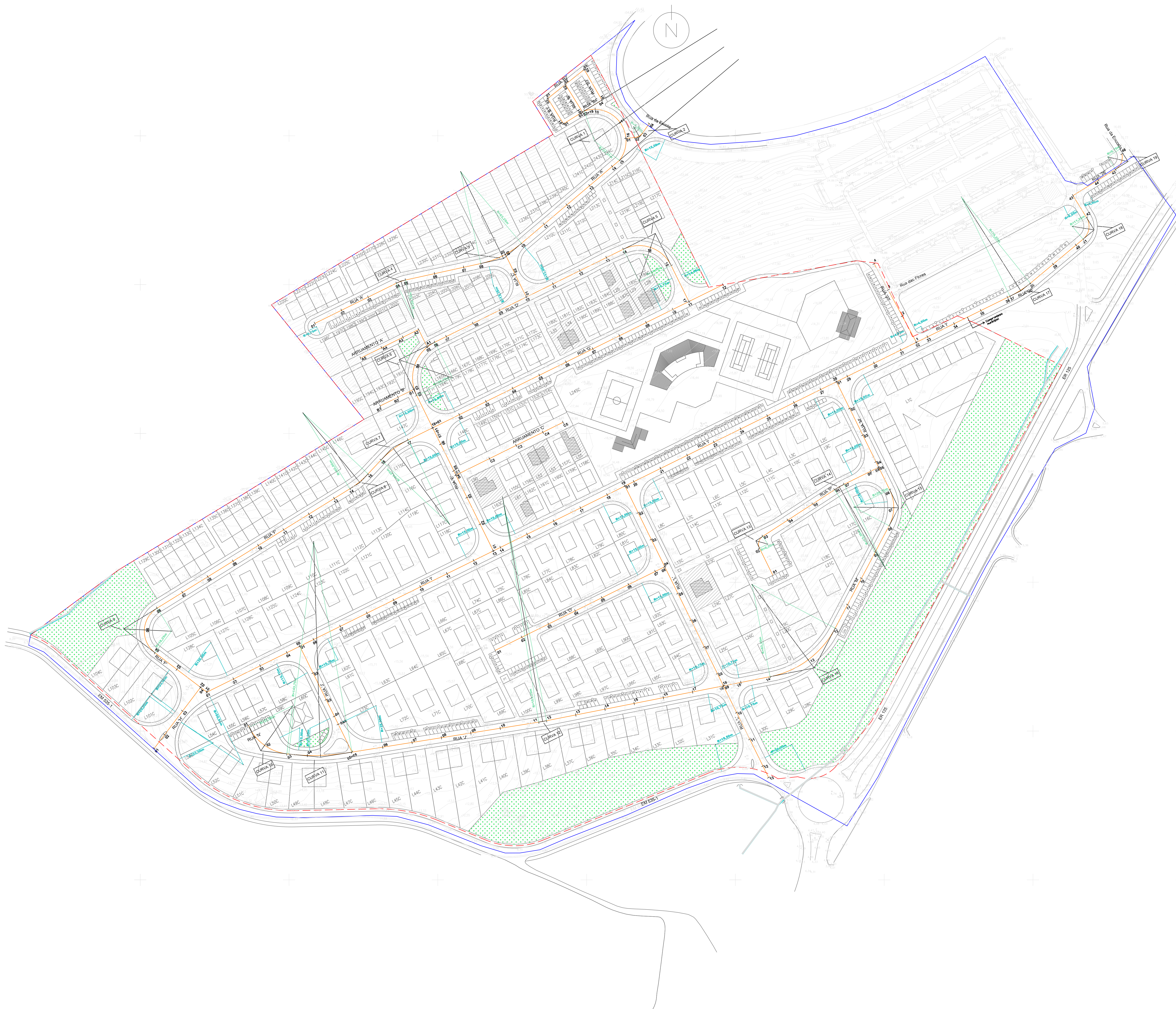
Planta geral da rede viária sobre planta topográfica Escala 1:1000
