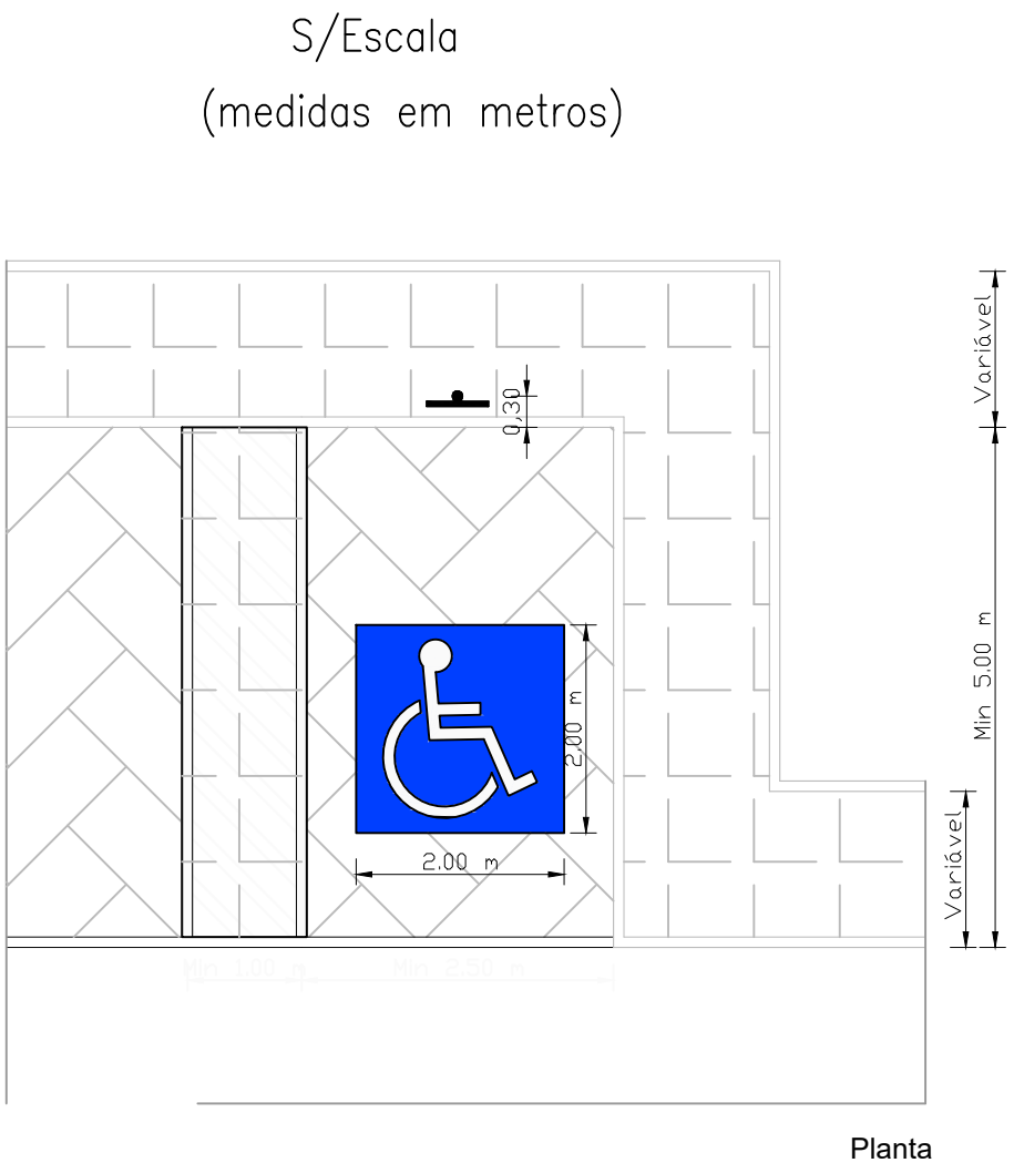
Pormenor tipo dos lugares reservados a veículos em que um dos ocupantes seja uma pessoa com mobilidade condicionada S/Escala
