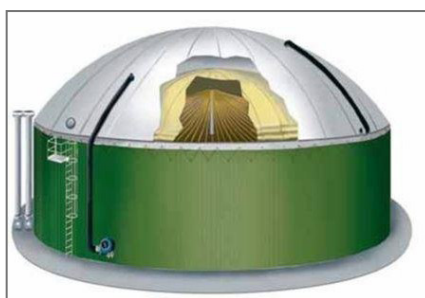
Figura III.14 – Cobertura de Dupla Membrana
