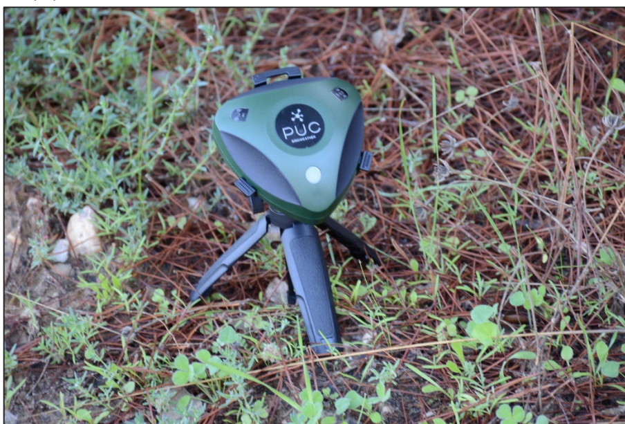
Foto IV.5 – Equipamento de bioacústica Birdweather PUC utilizado nos levantamentos de campo
