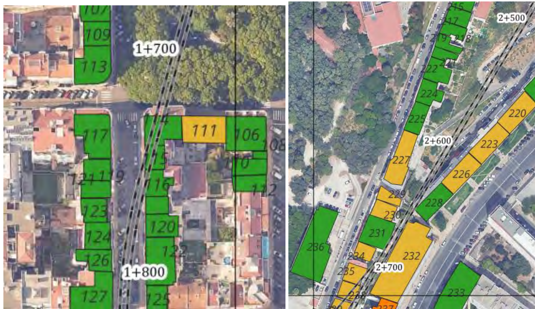
Figura 6: Destaque dos edifícios onde se prevê incumprimento dos limites de ruído re-radiado ( v_{ef} > 0.02 mm/s; edifícios numerados não a verde; km 1+700 a km 1+800 e 2+500 a km 2+700)
