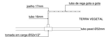
PR 6 | esqema de instalação de rega gota-a-gota
