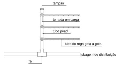
PR 5 | esqema de instalação de rega gota-a-gota
