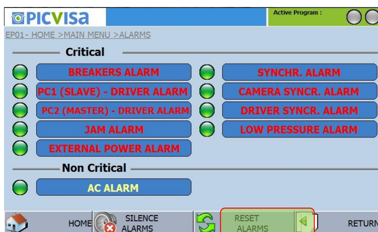
Figura 3 - Ecrã de controlo menu de alarme
