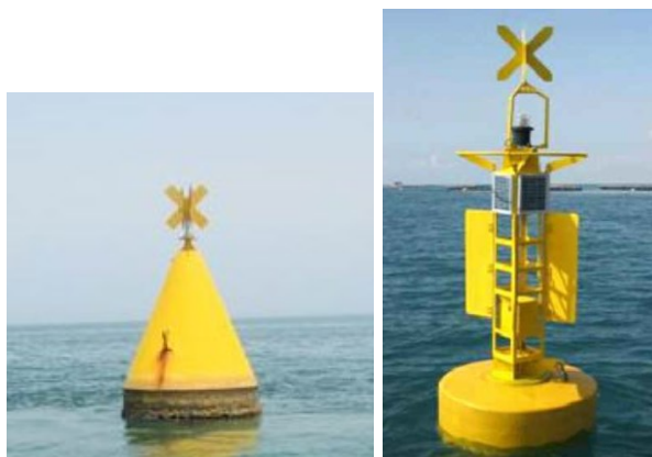
Ilustração 6. Exemplo de bóias de marcação especial
