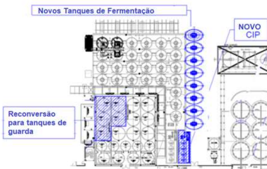
Figura 9 - Adega de Fermentação e guarda com os novos tanques
