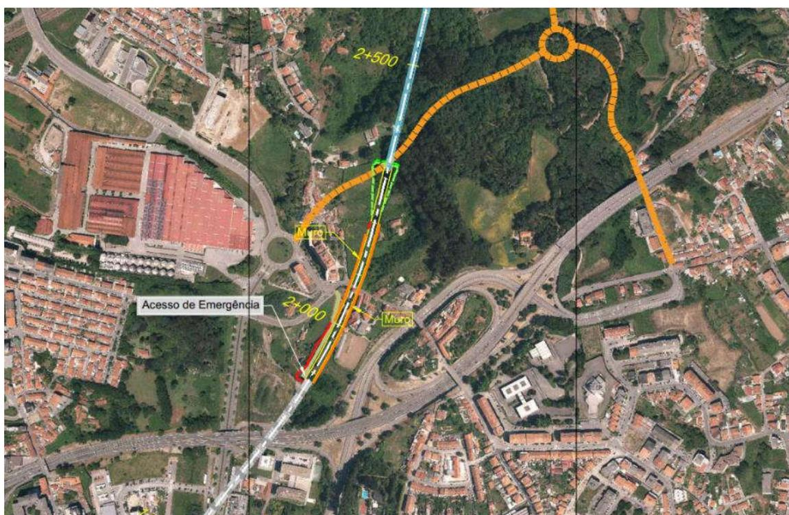
Figura 5.60 – Solução C, em túnel, escavação, aterro e viaduto (ponte), na zona de Oliveira do Douro
