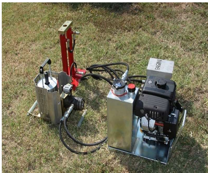
Figura 8 – Equipamento PDM utilizado para a realização das sondagens de penetração dinâmica.
