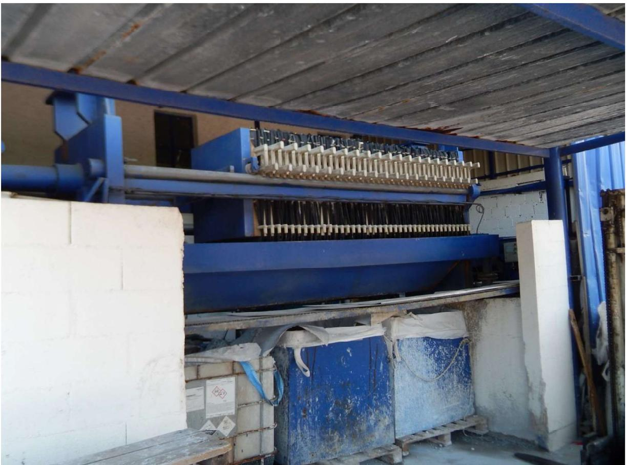
Figura 2 – Prensa de Desidratação de Lamas
