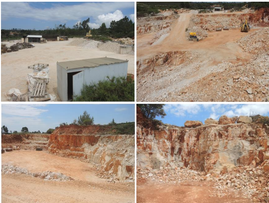
Figura 9 – Fotos 1 e 2 (cima esquerda, cima direita) – Vista geral da atual área do projeto licenciada; Foto 5 e 6 (baixo esquerda, baixo direita) – Bancada de exploração localizada junto ao limite SE e pormenor da fracturação de superfície.
