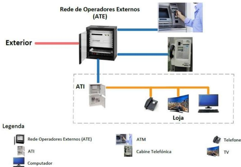
Figura 2 – Diagrama do Sistema ITED
