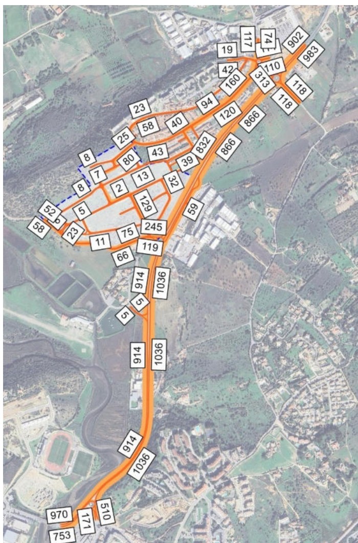
Figura 46 | Estimativas de tráfego em 2040 na HPT-DU (uvl/h) - Com empreendimento - Inverno - Cenário base
