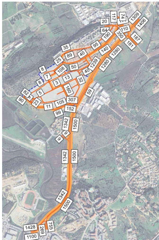
Figura 50 | Estimativas de tráfego em 2040 na HPT-DU (uvl/h) - Com empreendimento - Verão - Cenário base
