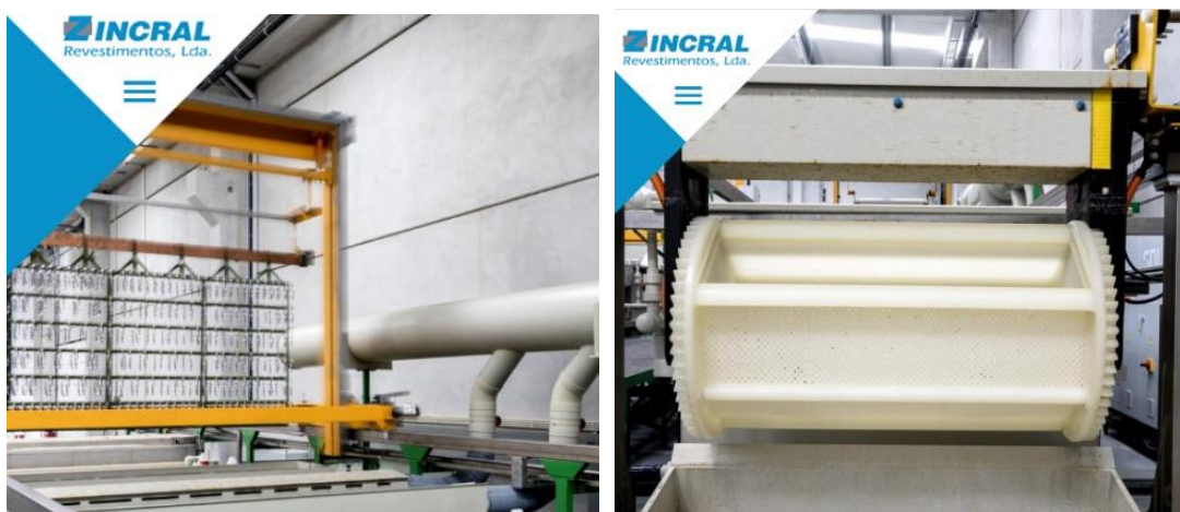
Figura 14 - Linha de suspensão por bastidores e linha de tambor da ZINCRAL.
