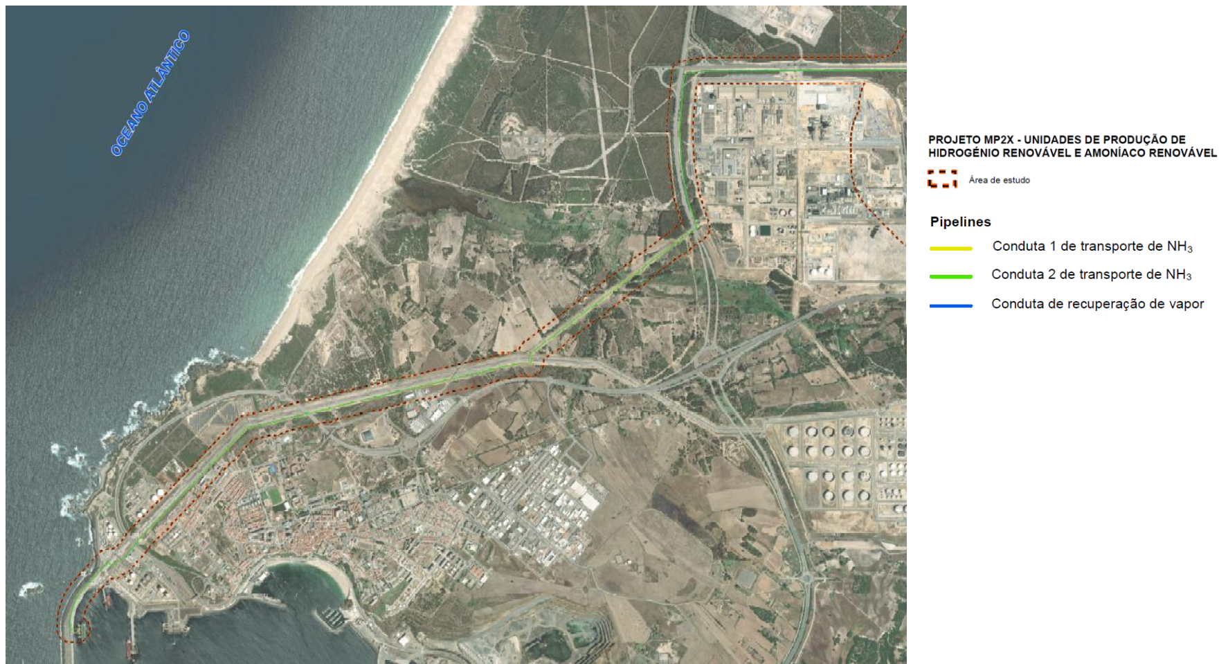
Figura 4 – Conduta de Transporte de NH 3
