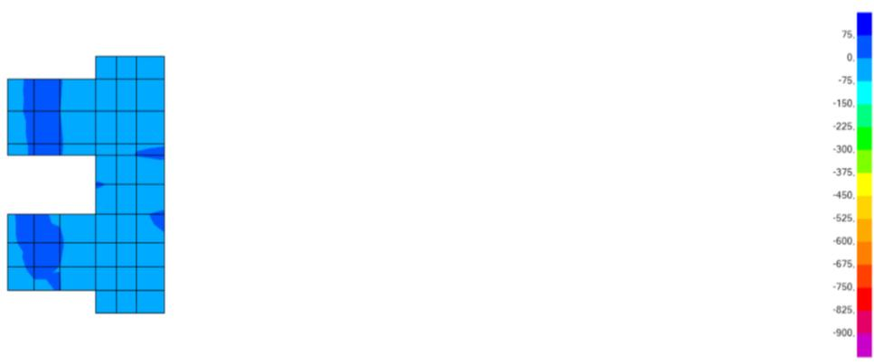
**Figura 7.23 – Estrutura de Tomada de Água e Descarga de Segurança - Laje intermédia. Diagrama de Momentos Fletores Mxx. Envolvente mínima**
