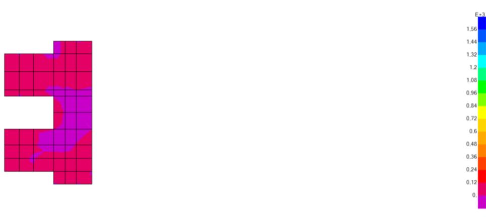
**Figura 7.20 – Estrutura de Tomada de Água e Descarga de Segurança - Laje intermédia. Diagrama de Momentos Fletores Myy. Envolveinte máxima**
