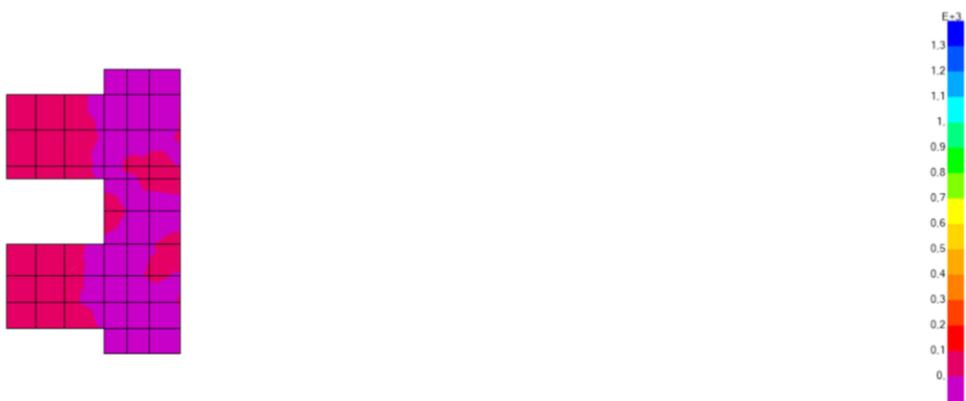
**Figura 7.22 – Estrutura de Tomada de Água e Descarga de Segurança - Laje intermédia. Diagrama de Momentos Fletores Mxx. Envolveinte máxima**
