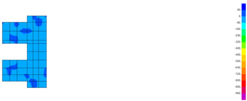
**Figura 7.21 – Estrutura de Tomada de Água e Descarga de Segurança - Laje intermédia. Diagrama de Momentos Fletores Myy. Envolveinte mínima**
