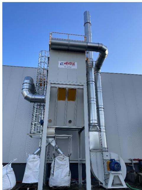
A descarga das poeiras na tremonha é assegurada por um sem-fim transportador, apoiado em duas chumaceiras de topo e acionado por moto-reductor e por uma válvula rotativa acionada por um moto-reductor.
